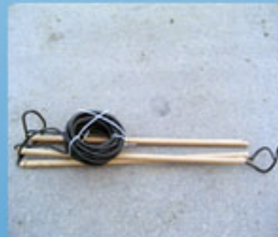
工厂预制式分段深井阳极串
