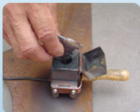
第三步：剪开塑料袋，将焊剂倒入模腔。
