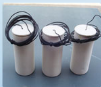
双陶型参比电极组装电极体
